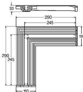
**Соединительный элемент Advantix Vario 90°**
