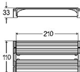
**Соединительный элемент Advantix Vario**
