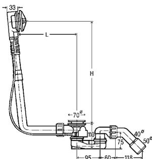
**Слив/перелив Multiplex функциональный узел плоская конструкция – требуется только 33 мм свободного пространства за ванной**
