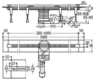
**Базовый элемент душевого лотка Advantix Vario произвольно укорачиваемый**
