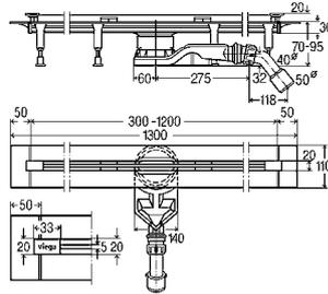
**Базовый элемент душевого лотка Advantix Vario произвольно укорачиваемый, 70 мм, (плоская модель)**
