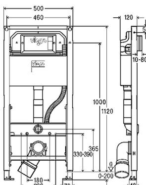
**Элемент для унитаза Prevista Dry с подключением для унитаза-биде, 1120 мм**
