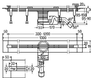
**Душевой лоток Advantix Vario произвольно укорачиваемый**
