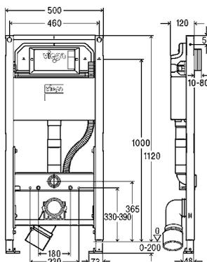
**Элемент для унитаза Prevista Dry с возможностью регулировки унитаза по высоте, с подключением для унитаза-биде, 1120 мм**
